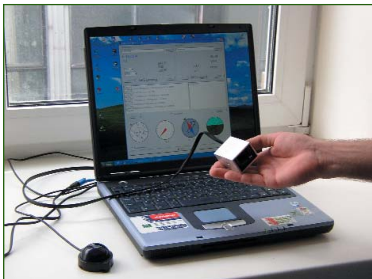
MEMS/GPS — малогабаритная интегрированная навигационная система
